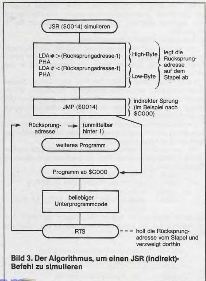
**Bild 3. Der Algorithmus, um einen JSR (indirekt)-Befehl zu simulieren**
